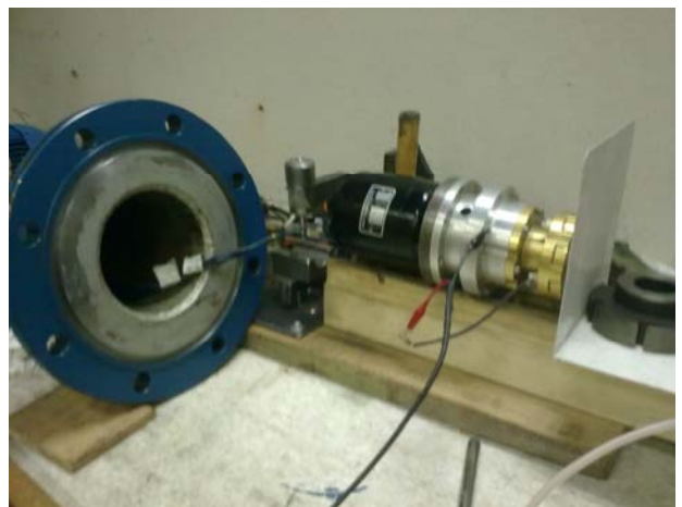
Vista del GVM en el banco de pruebas, con la chapa enfrentada a una distancia de 15 mm, la cual se carga con alta tensión mediante una fuente.
