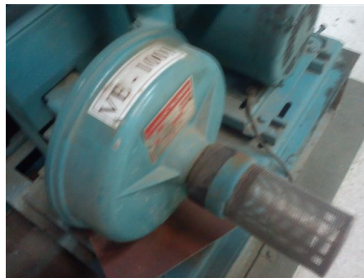
Figura 8: Motor ventilador de impulsión de aire
