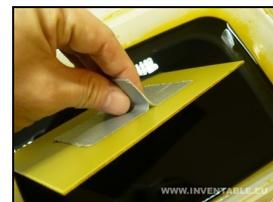
Al quedar sólo el Cu que estaba cubierto por el toner transferido por calor, se limpia exhaustivamente la placa con agua para retirar los restos que pudieran quedar de Cloruro Férrico. Luego, dado que la cobertura de toner no permite realizar las soldaduras necesarias para la instalación de las resistencias, se procedió a remover los restos de este producto también de modo de tener la superficie del Cu totalmente desnuda y limpia.
