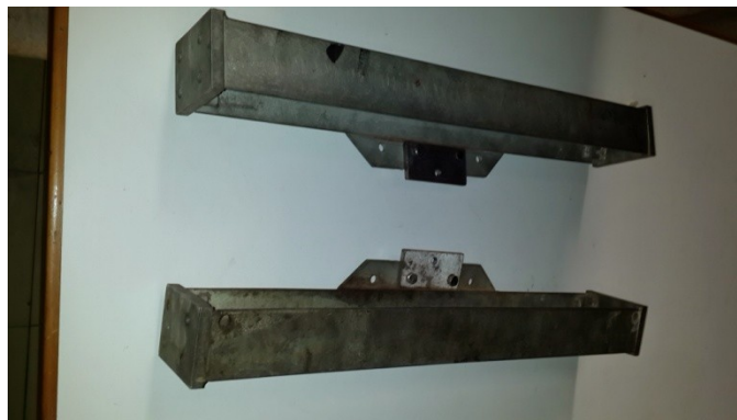
Figura 5: Soportes para sostener la columna de aceleración
