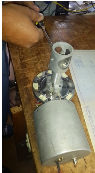
Figura 3: Electrodo de medición y motor posicionador de FC 01-1
