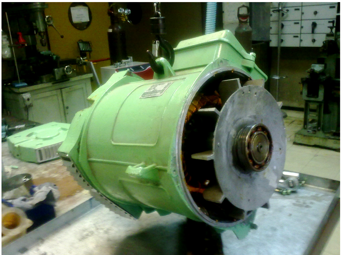
FIGURA N° 9: El motor eléctrico del RS CB1 en el taller para realizarle el control y las modificaciones necesarias.
