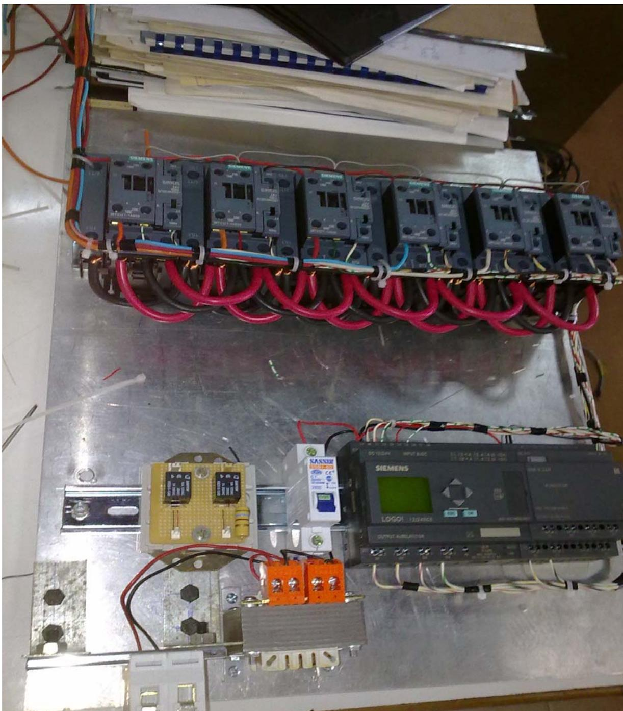
**I5-**Vista de los componentes y cableado del nuevo selector de cuadrupolos durante su armado
