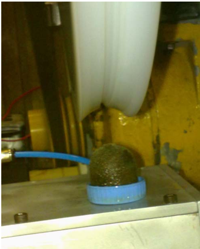
Fig. 4. Tetón de fieltro embebido en aceite en la posición de "reposo".
