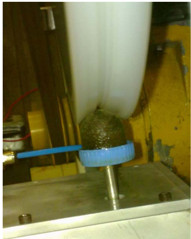
Fig. 5. Tetón de fieltro embebido en aceite en la posición de "actuado".
