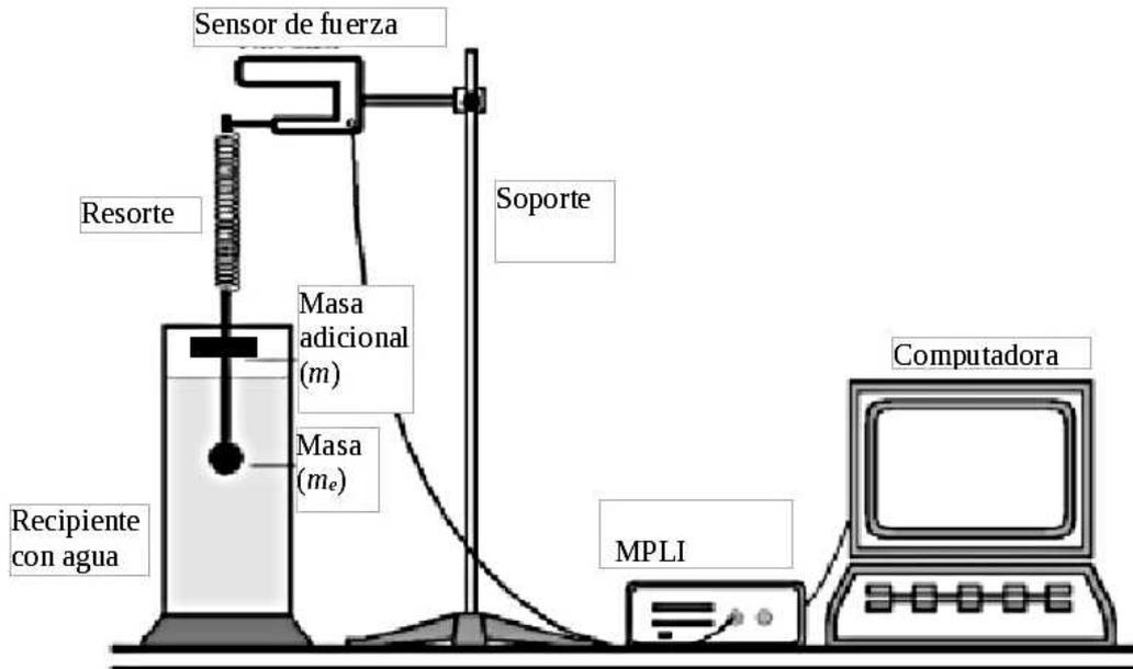
Figura 2: Esquema del dispositivo experimental
